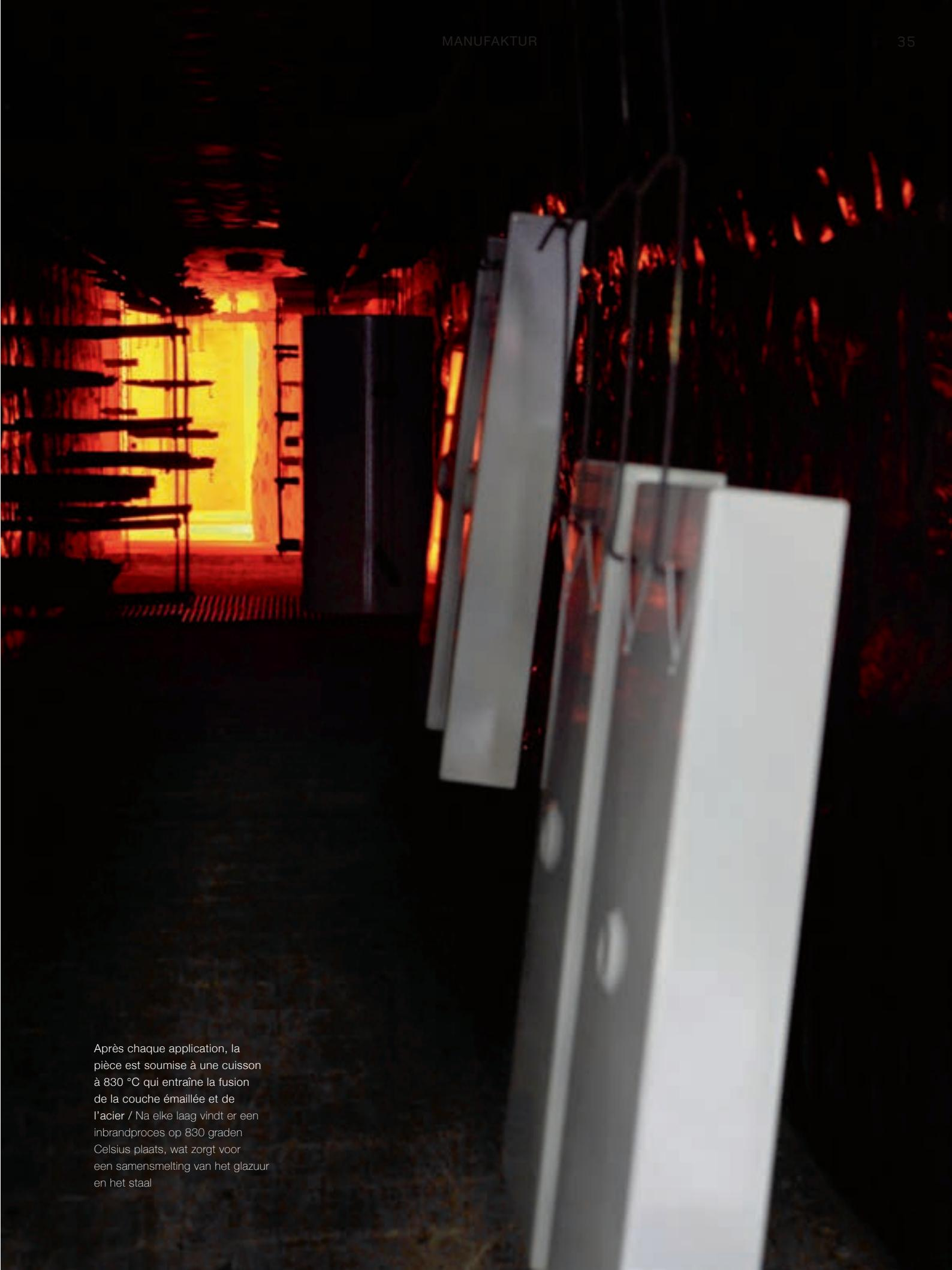
Après chaque application, la pièce est soumise à une cuisson à 830 °C qui entraîne la fusion de la couche émaillée et de l'acier / Na elke laag vindt er een inbrandproces op 830 graden Celsius plaats, wat zorgt voor een samensmelting van het glazuur en het staal
