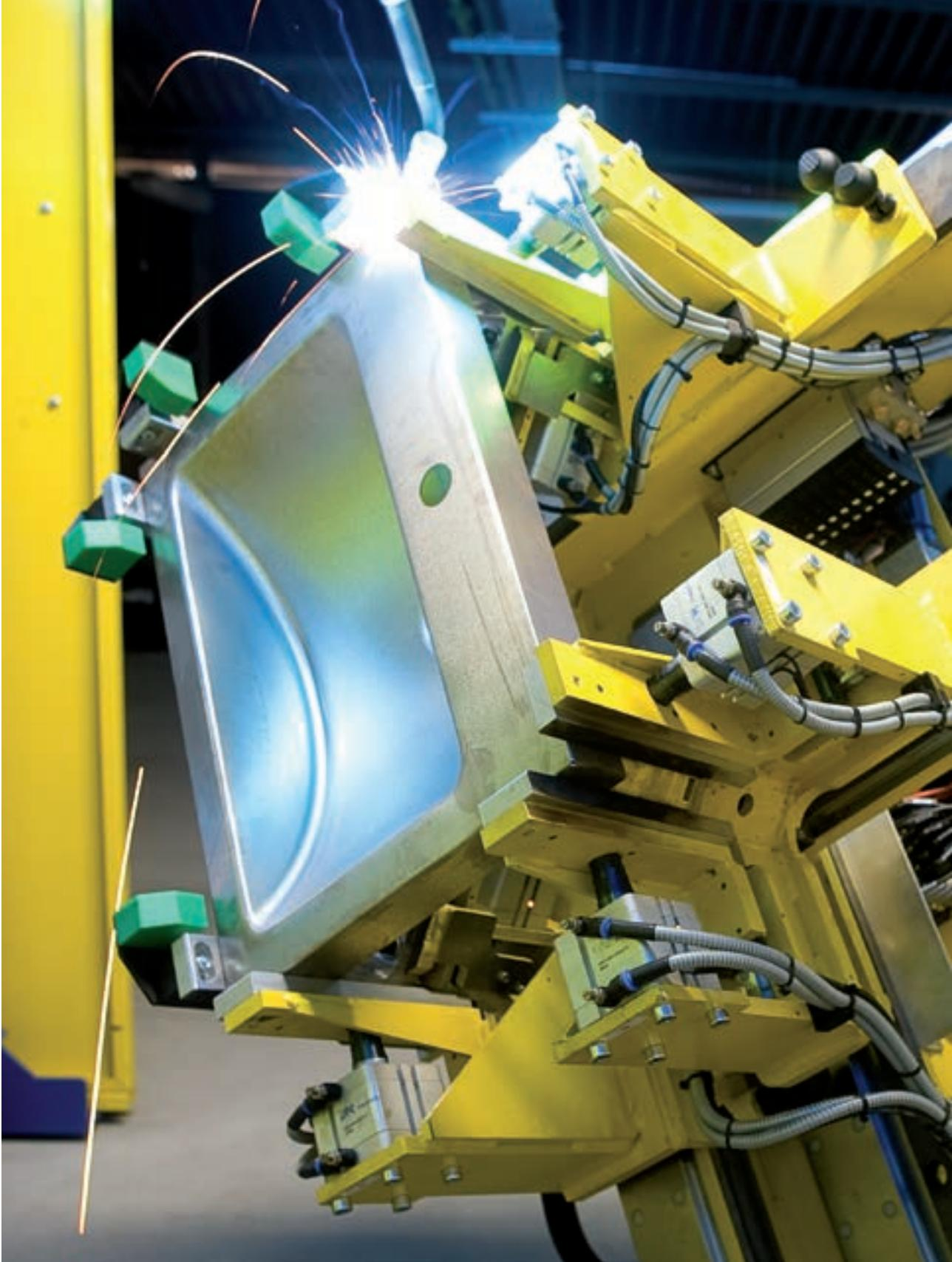
Les arêtes vives de la forme brute seront ensuite soudées et polies à la main ou à l'aide d'une machine grâce à un processus moderne préservant le matériau / In een modern, materiaal-besparend proces worden de open hoeken van de ruwe vorm hetzij met de hand of machinaal gelast en geslepen
