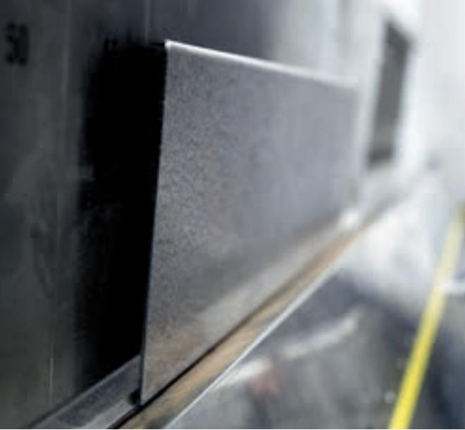
Le rognage de la plaque d'acier permet d'obtenir la hauteur de bord souhaitée pour la vasque ou le plan vasque / Door het afschuinen van de stalen plaat ontstaat de respectieve randhoogte van de waskom of wastafel
